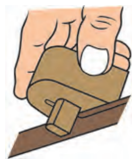
Erstellen eines Parallelriss mit dem Streichmaß
