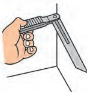
Abnehmen eines Winkels mit der Schmiege
